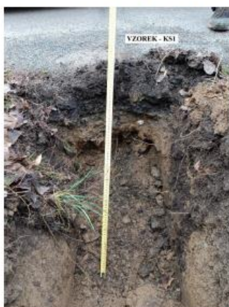
Obr. 37 – Kopaná sonda Vzorek – KS1 (in situ).
